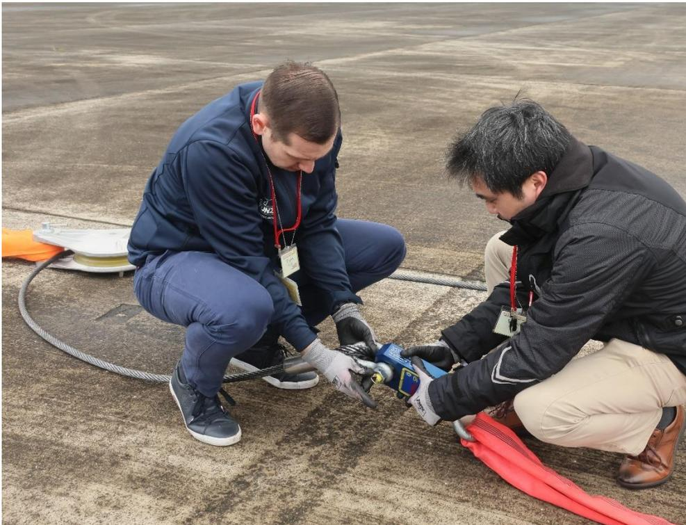
※牽引計(ロードセル)の設置作業
