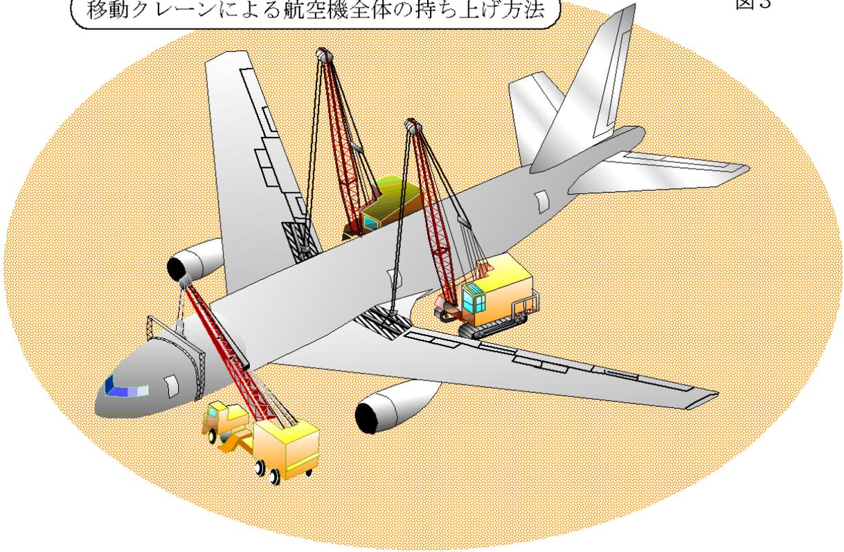
移動クレーンによる超大型機の持ち上げ方法
