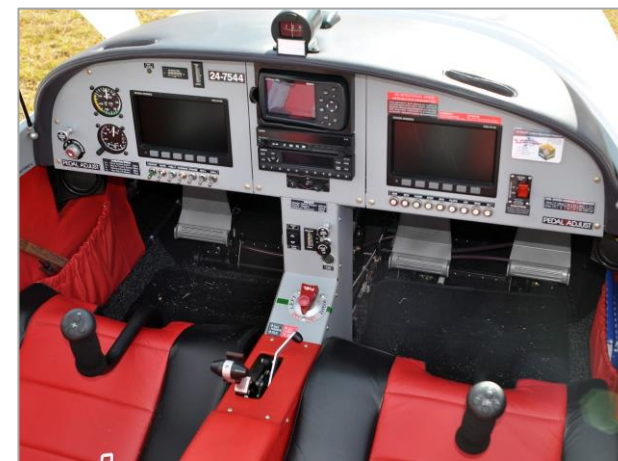
LSA の近代化された簡素な計器盤の例
